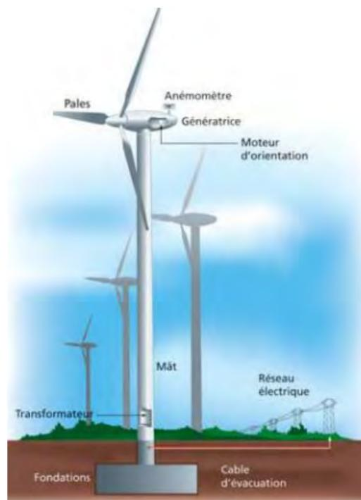
Figure 9: Représentation schématique d'une éolienne (Source : EDF)
